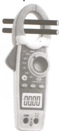
Неправильный способ измерения тока
